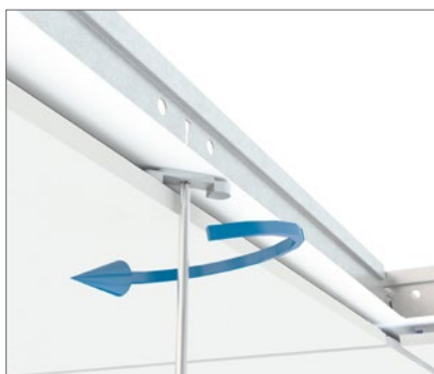
Монтаж фиксирующей клипсы с помощью отвертки.
